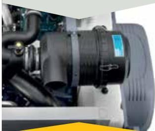
Clip per facile sostituzione del filtr
