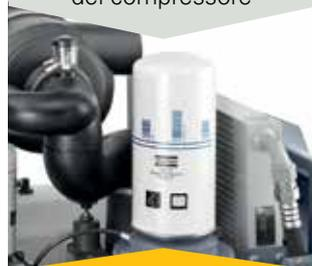
Filtro elemento separatore facilmente accessibile
